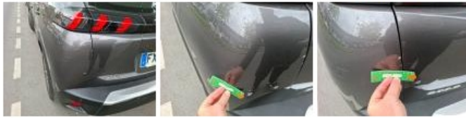
Moulure de pare-chocs AR, Griffe(s), E - Remplacer
