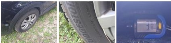
Pneu AVD, Hors tolérance, E - Remplacer
