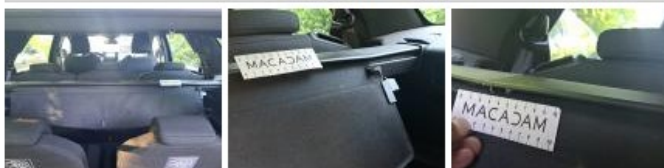
Cache bagages, Déformé / Forcé, Réparer/rempl. (montant forfaitaire)
