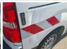
Porte coulissante D, Bosse(s) et griffe(s), Le - Remplacer et peindre
