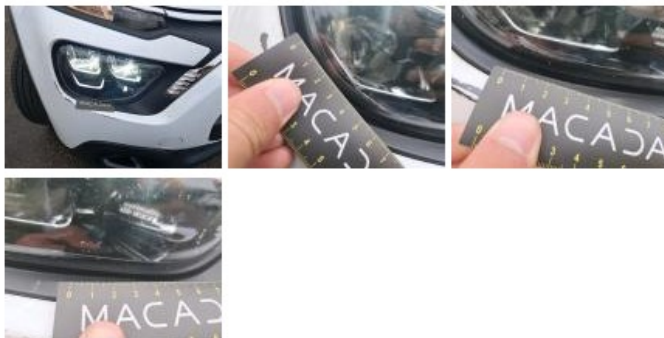
Moulure de pare-chocs AV, Griffe(s), E - Remplacer
