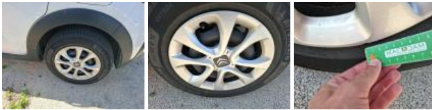
Enjoliveur de roue AVD, Cassé, E - Remplacer
