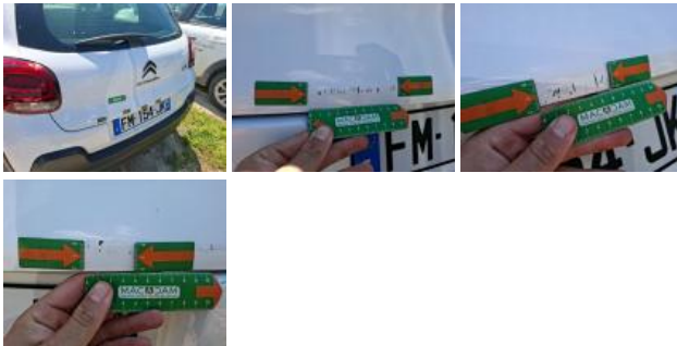
Pare-chocs AR, Griffe(s), Réparer/rempl. (montant forfaitaire)
