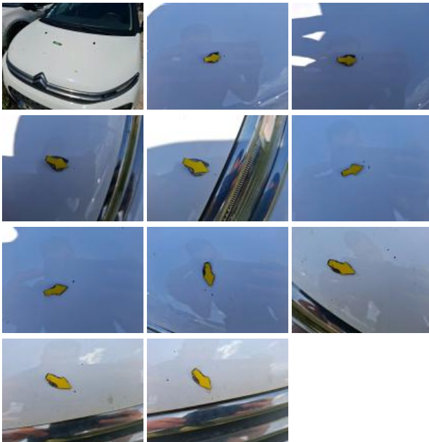
Pare-chocs AV, Griffe(s), E - Remplacer
