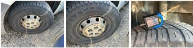
Pneu AVD, Hors tolérance, E - Remplacer
