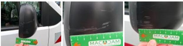
Boitier rétroviseur ext D, Griffe(s), E - Remplacer
