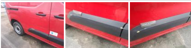
Moulure porte AVD, Griffe(s), Acceptable
