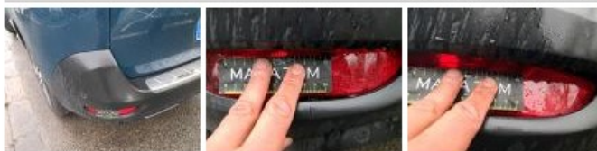
Feu antibrouillard ARG, Cassé, E - Remplacer
