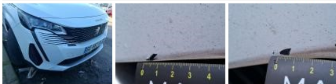
Moulure de pare-chocs AV, Fêlure, Acceptable
