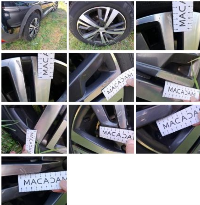
Jante alum. AVD bi-ton/polychrome, Griffe(s), Réparer/rempl. (montant forfaitaire)
