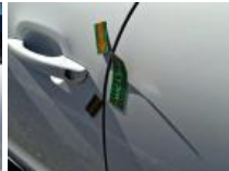
Porte AV, Bosse(s) et griffe(s), LI - Réparer et peindre (complet)
