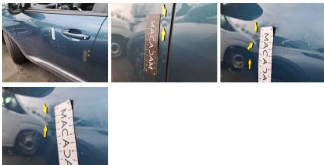
Moulure d'aile AVG, Griffes(s), Acceptable
