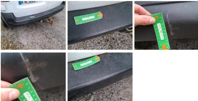
Pavillon caisse, Bosse(s) et griffe(s), LI - Réparer et peindre (complet)
