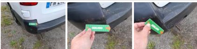
Coin pare-chocs ARG, Griffe(s), E - Remplacer
