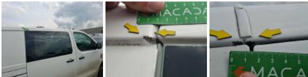
Joint de coffre/hayon, Déchirure, E - Remplacer
