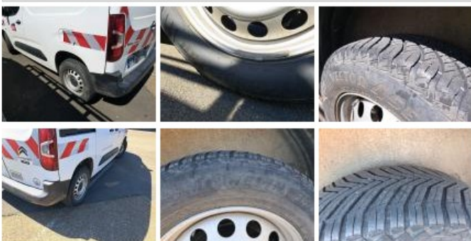
Pneu AVD, Hors tolérance, E - Remplacer
