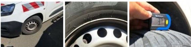
Pneu ARG, Usé, E - Remplacer
