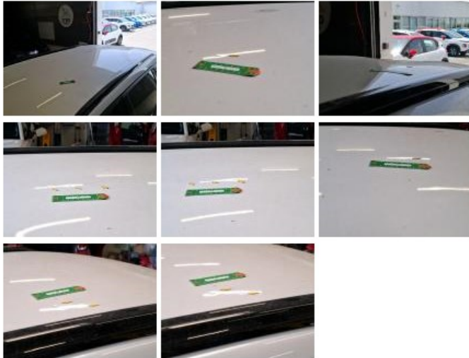
Pavillon, Bosse(s), LI - Réparer et peindre (complet)
