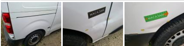
Pare-chocs AR, Cassé, E - Remplacer
