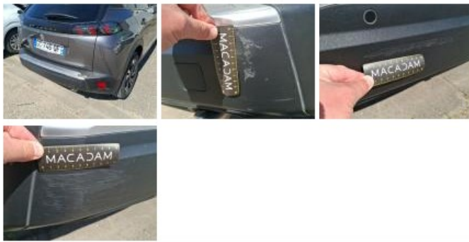
Moulure de pare-chocs AR, Griffe(s), Acceptable
