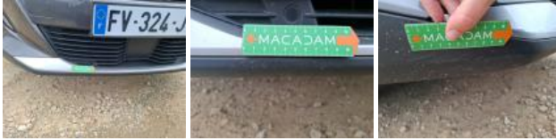
Moulure de pare-chocs AV, Griffe(s), Acceptable
