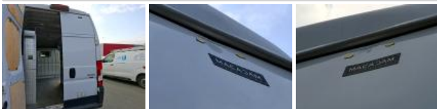
Serrure de coffre, Manque, E - Remplacer
