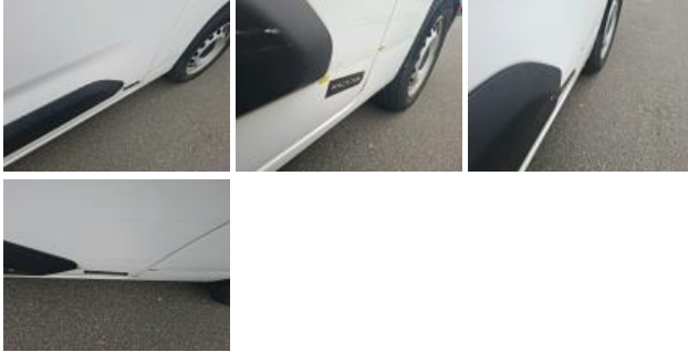
Coin de panneau ARG, Bosse(s) et griffe(s), LI - Réparer et peindre (complet)
