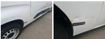
Coin de panneau ARD, Bosse(s) et griffe(s), LI - Réparer et peindre (complet)
