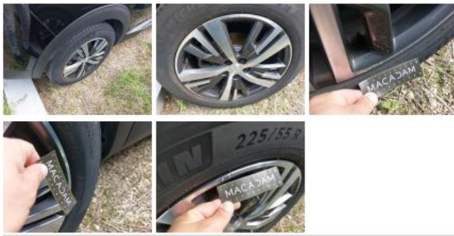
Pneu AVD, Hors tolérance, E - Remplacer
