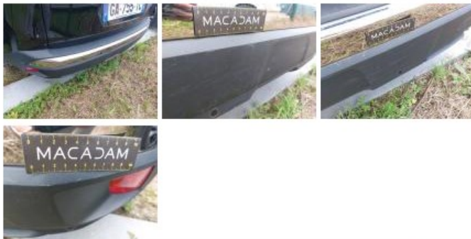
Obtuteur /Cache AR, Déformé / Forcé, E - Remplacer
