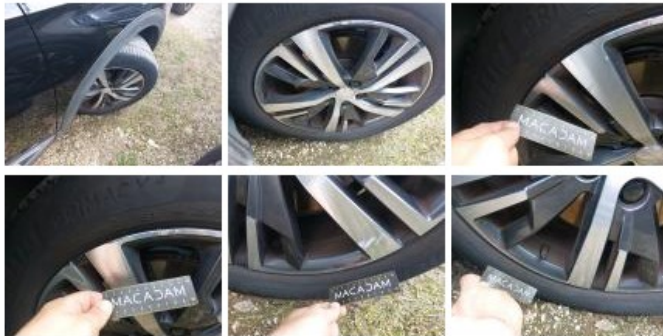
Pneu AVG, Hors tolérance, E - Remplacer
