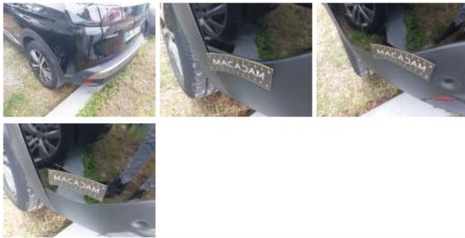
Moulure de pare-chocs AR, Fêlure, E - Remplacer
