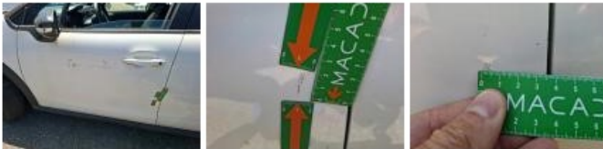
Serrure de porte AVG, Forcé, E - Remplacer
