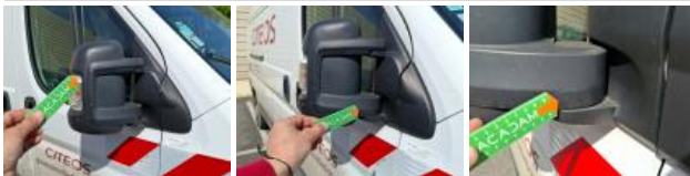
Boitier rétroviseur ext D, Cassé, E - Remplacer
