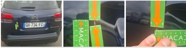
Pare-chocs AR, Mauvaise réparation, LI - Réparer et peindre (complet)
