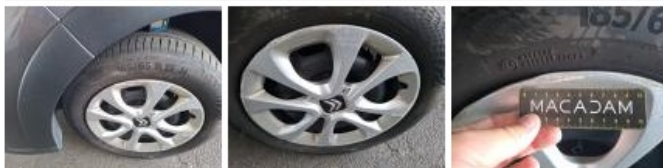
Pneu ARD, Hors tolérance, E - Remplacer
